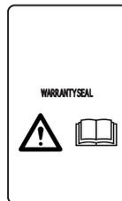
El chasis tiene componentes sensibles a descargas electrostáticas (ESD). Además, el chasis es una pieza importante del diseño del robot cortacésped y se debe volver a sellar de manera profesional si el producto va a ser utilizado en exteriores. Por este motivo, el chasis solo podrá ser abierto por técnicos de mantenimiento autorizados. Un sello roto puede invalidar la totalidad o parte de la garantía.
